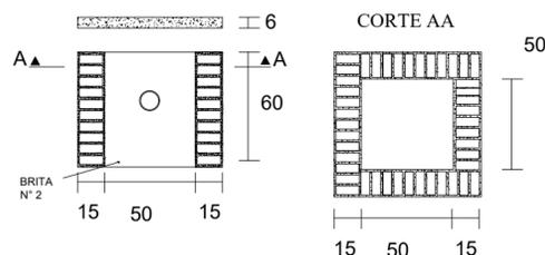
DETALHE CAIXA DE INSPEÇÃO
